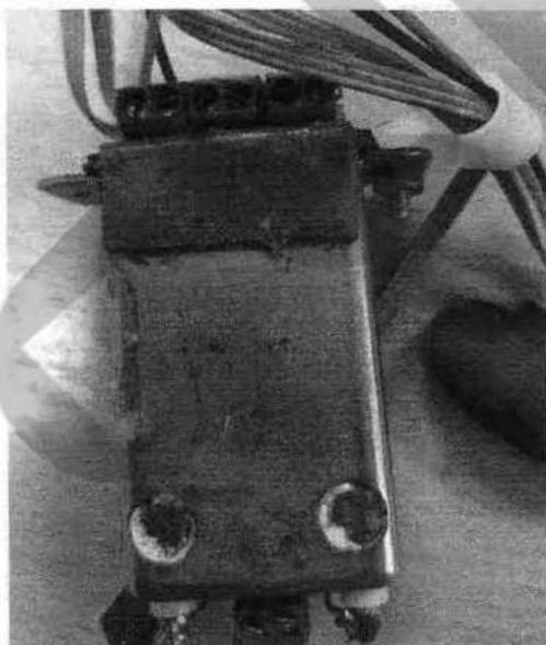
Рисунок 25 – Автономный блок трансмиттер, размещаемый на гребном валу
