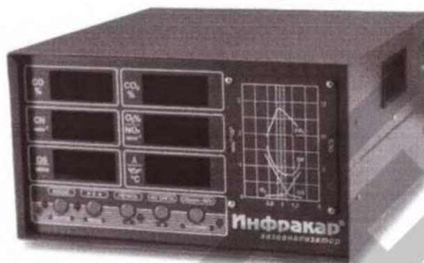
Рисунок 3 - Общий вид газоанализатора «Инфракар М 3.01»
