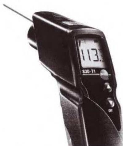
Рисунок 6 – Общий вид пирометра «Testo» 830-T1
