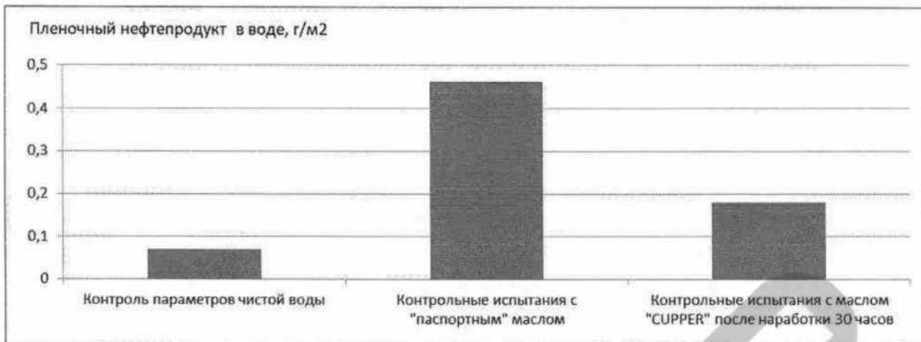
Рисунок 34 – Результаты измерения пленочного нефтепродукта в воде
